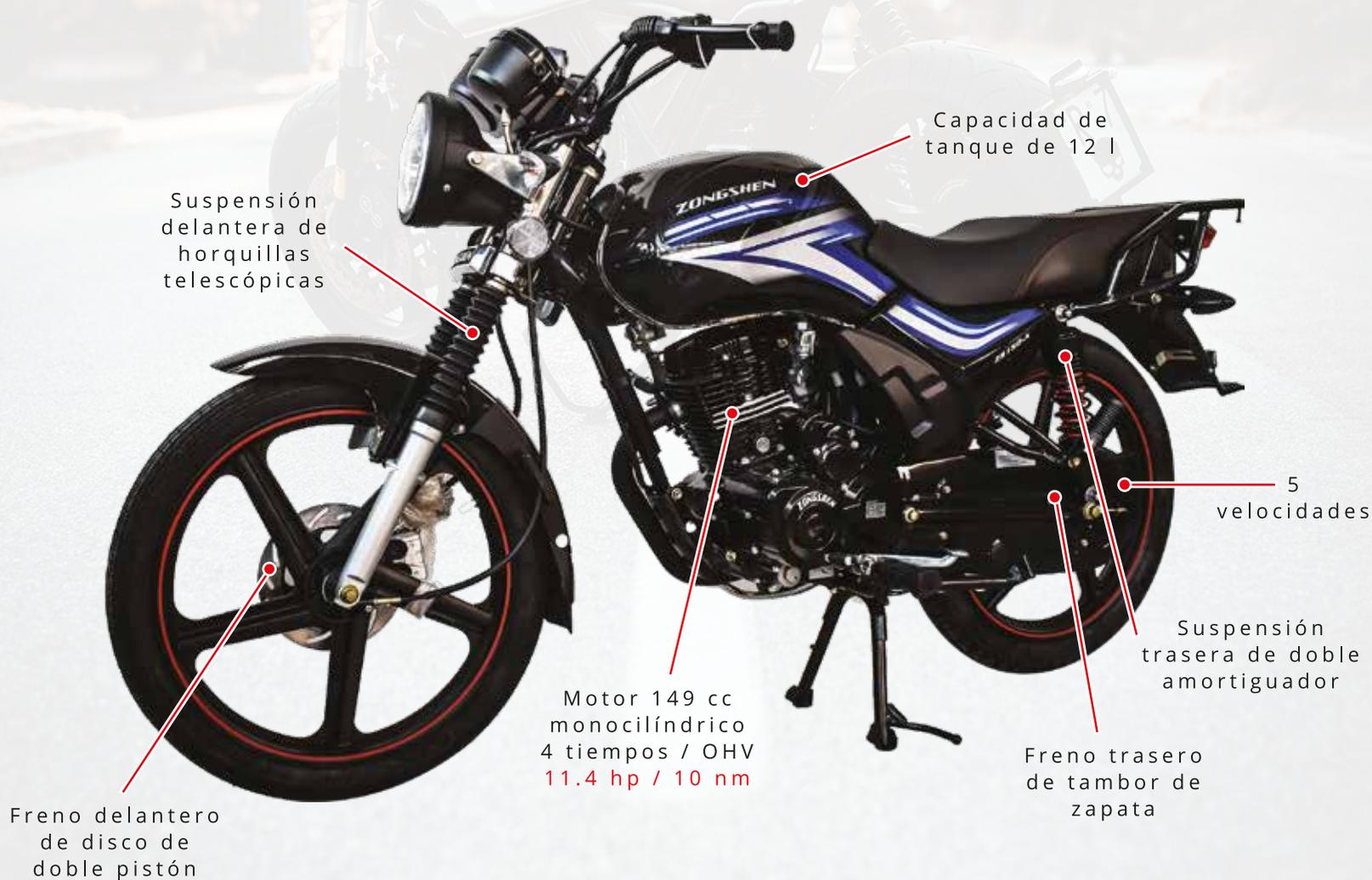
Suspensión delantera de horquillas telescópicas
