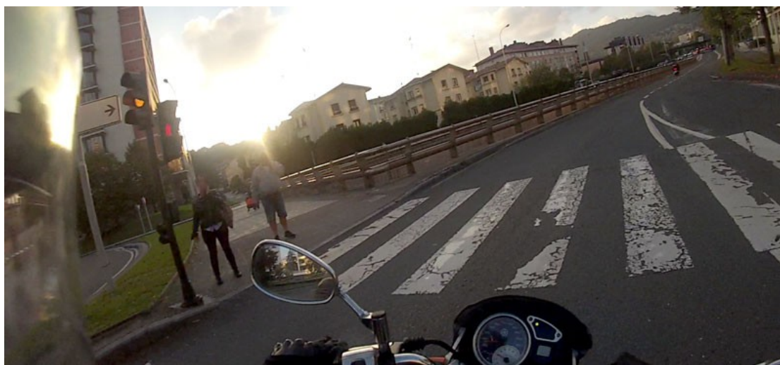
Un semáforo en ámbar intermitente da preferencia a los peatones, pero si ellos tienen luz roja resulta una indicación ambigua y puede provocar un peligro innecesariamente. Mal diseño.
