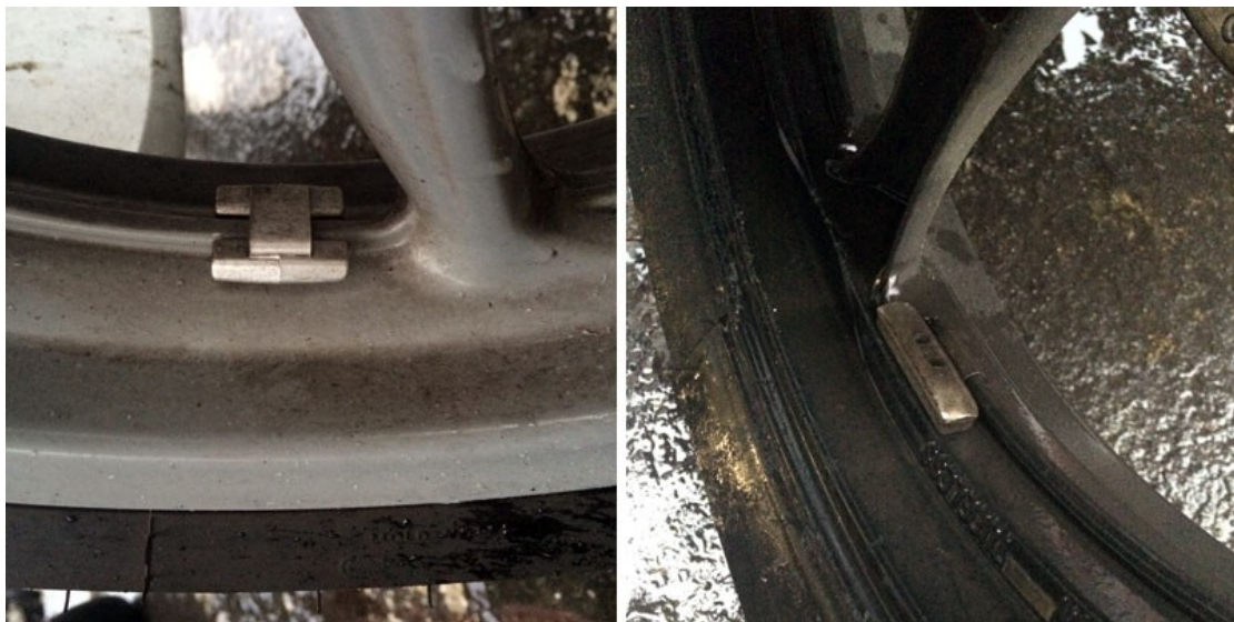
Estos pequeños bloques de plomo equilibran la rueda y evitan molestas vibraciones.
