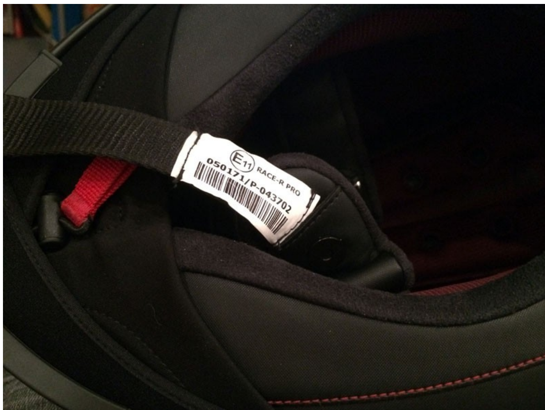
Etiqueta de un casco con homologación europea, cosida en el barbuquejo.
