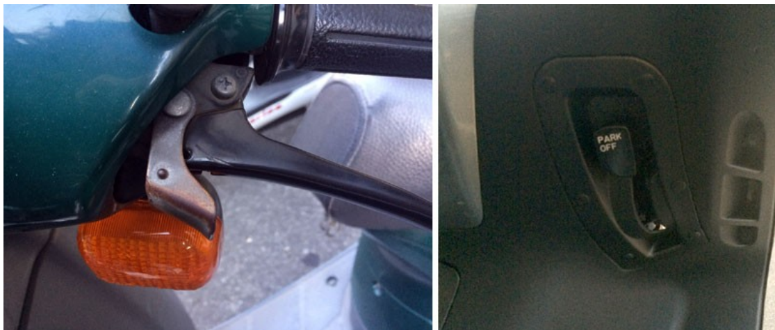
Algunos scooters vienen equipados con frenos de estacionamiento, más o menos sofisticados, a veces incluso automáticos.
