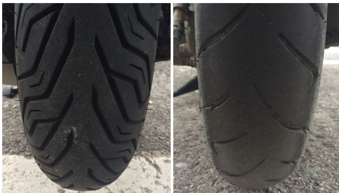
La diferencia entre un neumático con un dibujo profundo y otro en el que ya aparecen los chivatos , no es sólo visual. El comportamiento de la moto es totalmente diferente.
